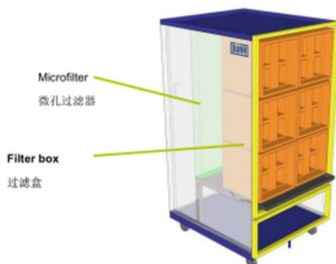
图 7.2-2 纸盒干式漆雾净化系统
